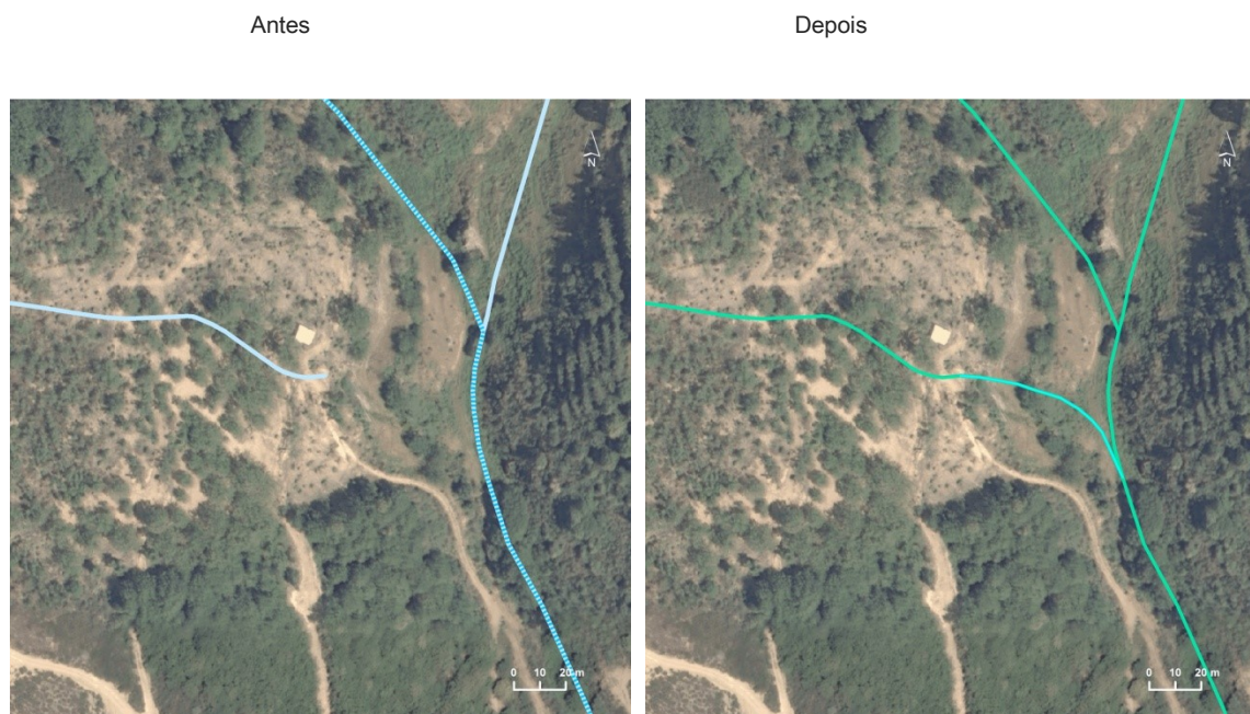
Figura 9 | Extrato exemplificativo do ajuste da hidrografia da cartografia de base homologada quando sem continuidade
