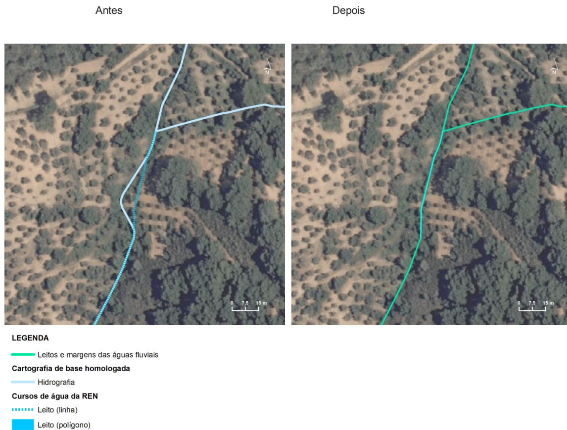
Figura 8 | Extrato exemplificativo do ajuste da hidrografia da cartografia de base homologada aos cursos de água da REN
