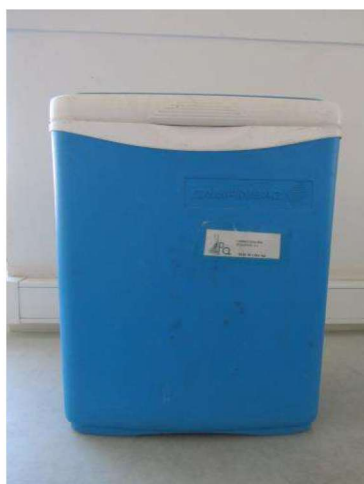
Exemplos de Arcas Térmicas para a Recolha, Acondicionamento e Transporte de Amostras
