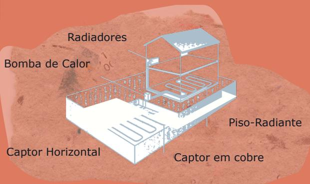
Fig. 14- esquema de um aproveitamento de energia geotérmica de baixa temperatura.
